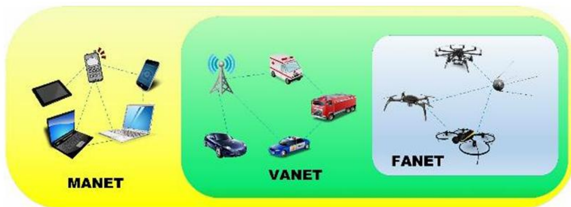
2.2-сурет – MANET, VANET және FANET мақсатты желілерінің құрылымы
