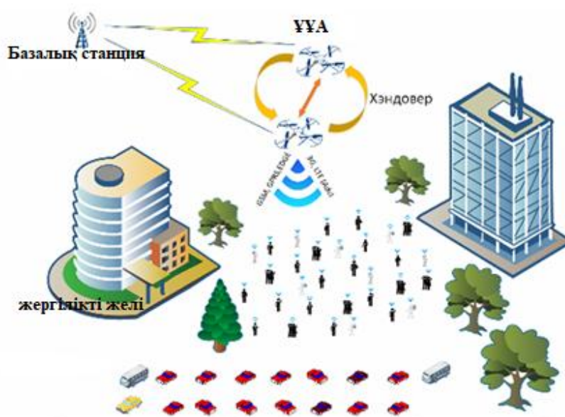
3.33-сурет – Мобильді құрылғылармен жылжымалы жер үсті желісіне арналған әдіс
