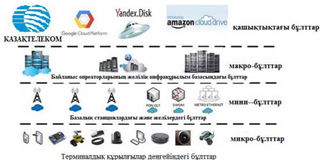
1.3-сурет – Тактильді интернет қызметтерін енгізу жағдайындағы бесінші буын байланыс желілері үшін көпдеңгейлі бұлттық инфрақұрылым жүйесі
